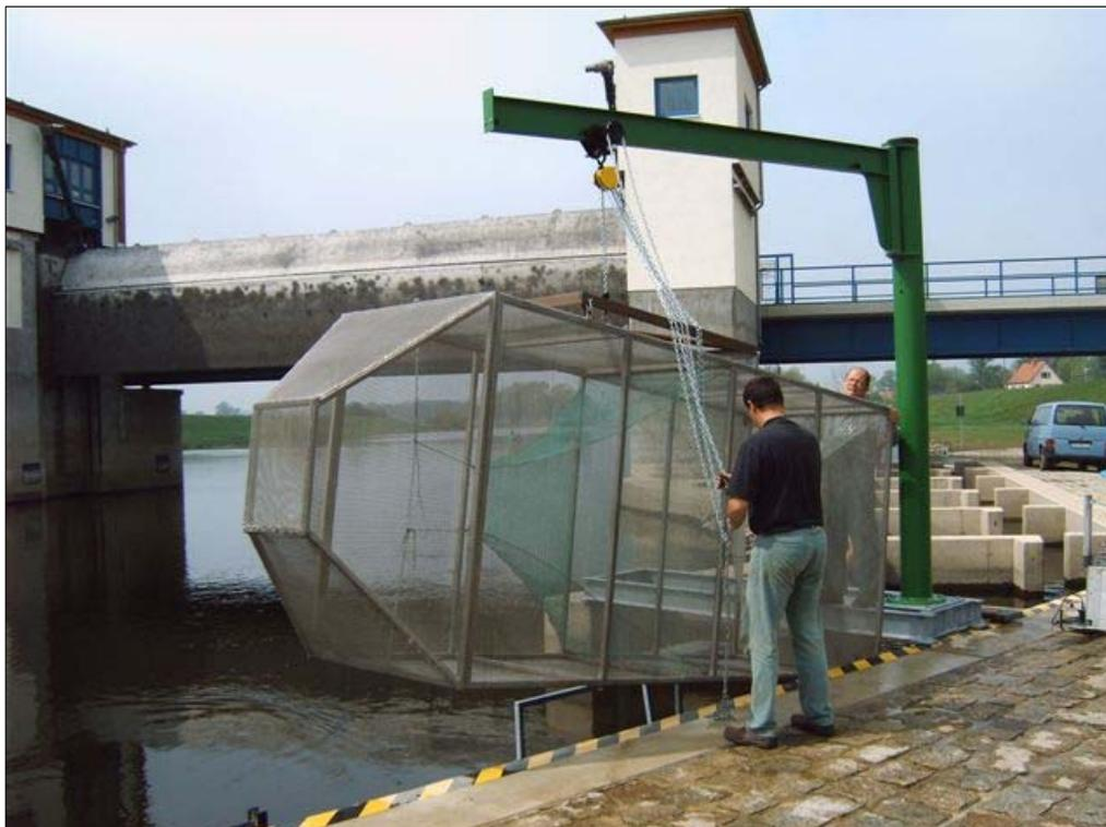
Abb. 2.4.1.1: Steigaalreuse an der Havelmündung (Wehr Gnevsvorf)
